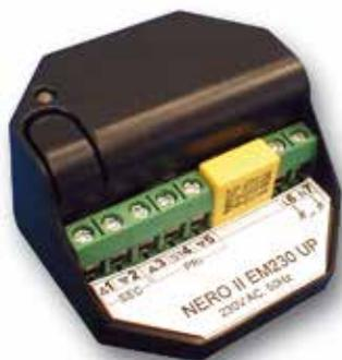
Mit dem Eingangsmodul NERO II EM230 UP wird das NERO II-System noch leistungsstärker und vielseitiger. Denn mit diesem Modul, das sich einfach in jeder Unterputzdose installieren lässt, können vorhandene Steuerungen mit 230V Ausgangsspannung in das System eingebunden werden. Damit deckt das NERO II-System über die klassische Rollladensteuerung hinaus zahlreiche zusätzliche Funktionalitäten ab.
