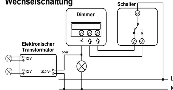
Mischbetrieb von Glühlampen + Elektronischer Transformator bis max. 200W Gesamtleistung möglich.
