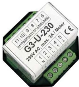
Das Trennrelais G3-U-230 dient der Steuerung einer Gruppe von Jalousie- und Rollladenmotoren. An jedem G3-U-230 können bis zu max. 3 Motoren angeschlossen und gleichzeitig gesteuert werden. Die Bedienung der Motoren erfolgt mit einem Jalousietaster / Jalousieschalter oder einer externen Steuerung. Durch den Anschluss von mehreren Jalousietastern kann bei Bedarf eine Mehrpunktbedienung von angeschlossenen Motoren realisiert werden.
