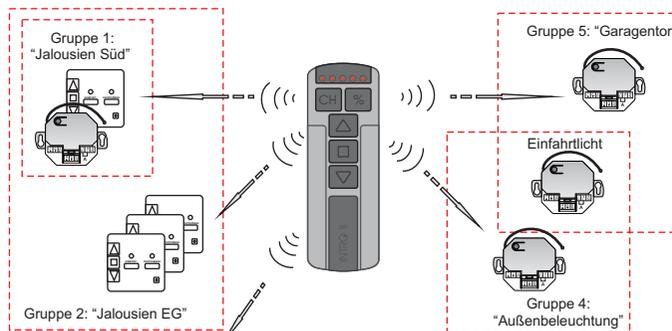
Auch Powerline-Steuerungen der NERO II - Produktfamilie können bei Bedarf vom Handsender mit Hilfe eines Transkoders mitgesteuert werden. Der Transkoder empfängt die Funkbefehle des Handsenders INTRO II HS5, wandelt diese in NERO II - Steuerbefehle um und sendet weiter durch das 230V-Hausnetz an die entsprechenden NERO II - Steuerungen.
